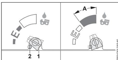
Lorsque la vis de réglage de débit d'huile (1) se trouve en position E (Ematic), le réglage du débit d'huile est optimal pour la plupart des travaux.
