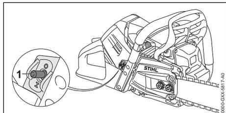
**1 Interrupteur de chauffage de poignées**
